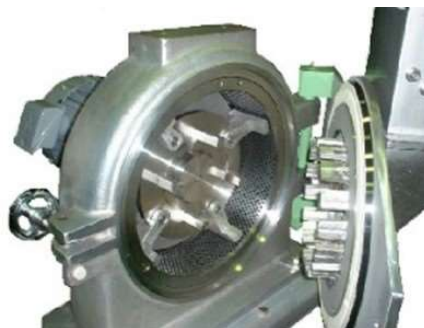
写真2 マキノ式粉砕機内部
