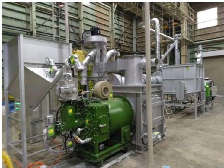
写真10 バイオコークス製造プラント2期工事分（破砕機+乾燥装置）の後面
