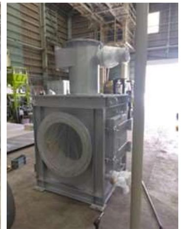
写真3 熱風発生炉
