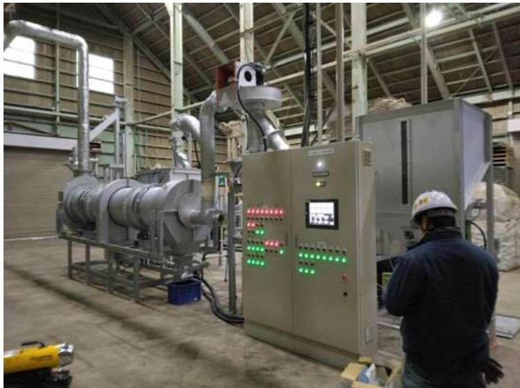
写真9 バイオコークス製造プラント2期工事分（破砕機+乾燥装置）の正面
