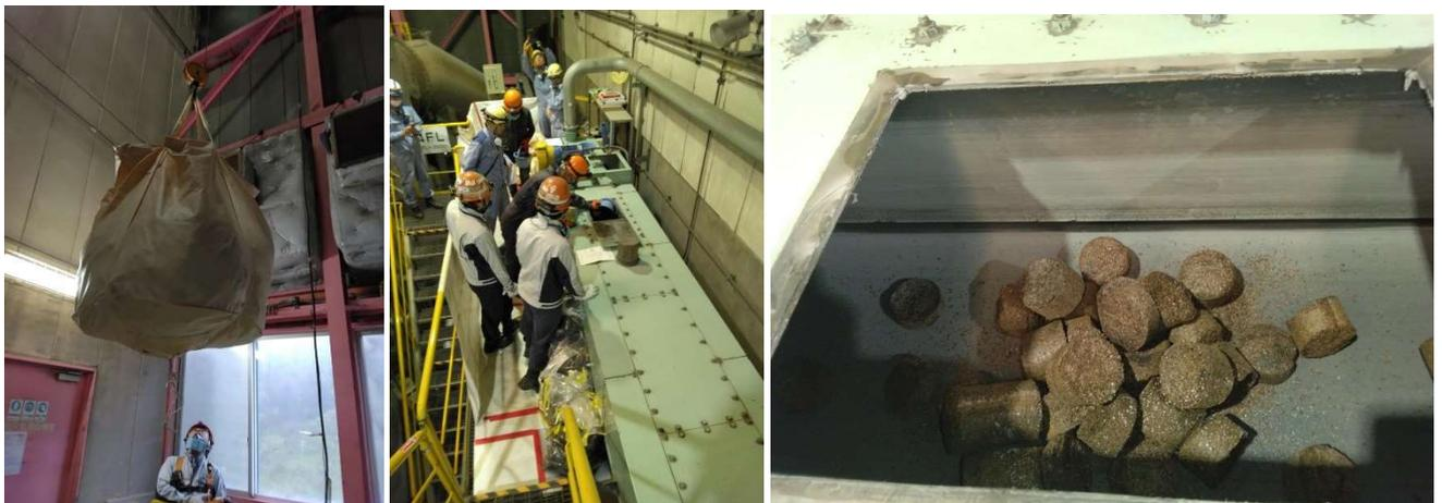
写真 13 道内自治体のシャフト式ごみ焼却炉での石炭コークス置換試験状況
