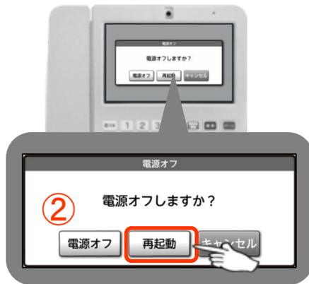
\*情報端末機裏面の「電源ボタン」操作を行わないで電源コードを抜くと、本商品が起動しなくなる場合があります。
